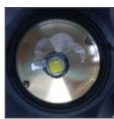
dioda CREE Q5 w modelach LB-230, LB-420
